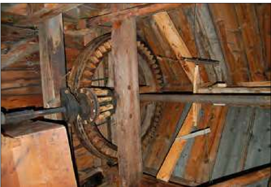
Fot. 4. Mechanizm młyński wiatraku w Kalembinie, widok na koło pałeczne, sochę i przekładnię. Fot. G. Stojak
